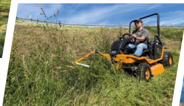
Insektenschonendes Mähen mit Scheuchvorrichtung
